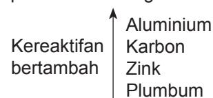
4. Pengekstrakan logam. Logam yang kurang reaktif daripada karbon dalam siri kereaktifan logam dapat diekstrak daripada bijihnya dengan penurunan oksida logam tersebut oleh karbon.
